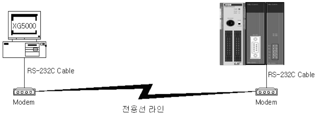
[그림 5.1.8] 전용모뎀을 통한 XG5000 리모트 접속 예
