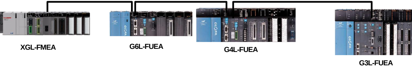
[그림 4.1.2] XGT Fnet + GM/MK Fnet으로 구성된 시스템
